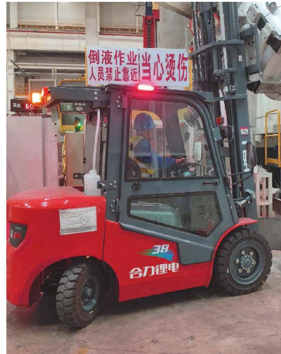
高溫鋁液加注到機邊保溫爐
